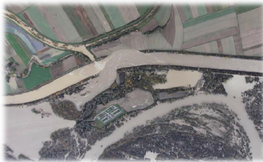
Slika 14.6: Preboj nasipa v obvodni kanal HE Zlatoličje (foto: arhiv Mensuras, d. o. o.)
