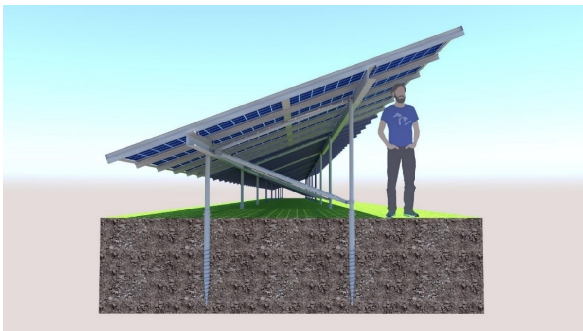
Slika 7: Prikaz prostostoječe postavitve FV modulov na podkonstrukciji (vir: Tehnično poročilo SE Dekani, 2024)
