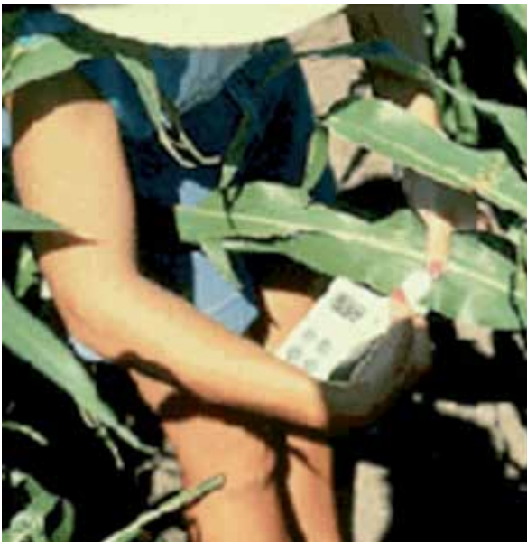
Slika 5: Meritve obarvanosti listov s klorofilomerom (N-tester ali SPAD meter)
