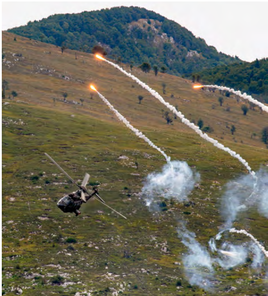
TOPLITNE VABE V STIKU Z ZRAKOM ZAGORIJO IN PREDSTAVLJAJO VIR TOPLOTE, KI ZMEDE TOPLITNO VODENE RAKETE.
