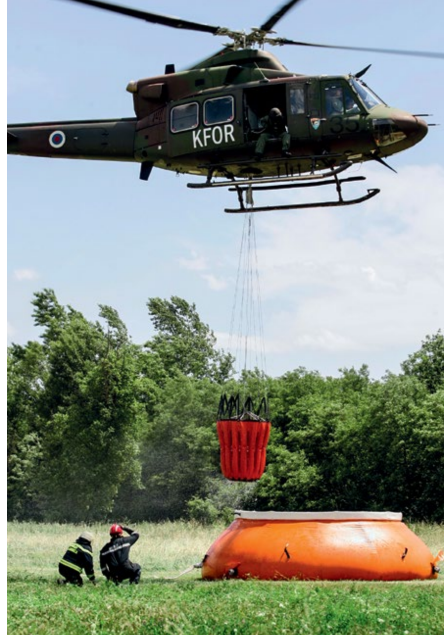
VSI HELIKOPTERJI SV SO OPREMLJENI S PODVESNO KLJUKO, NA KATERO SE LAHKO PRIPNE VREČA ZA GAŠENJE.
