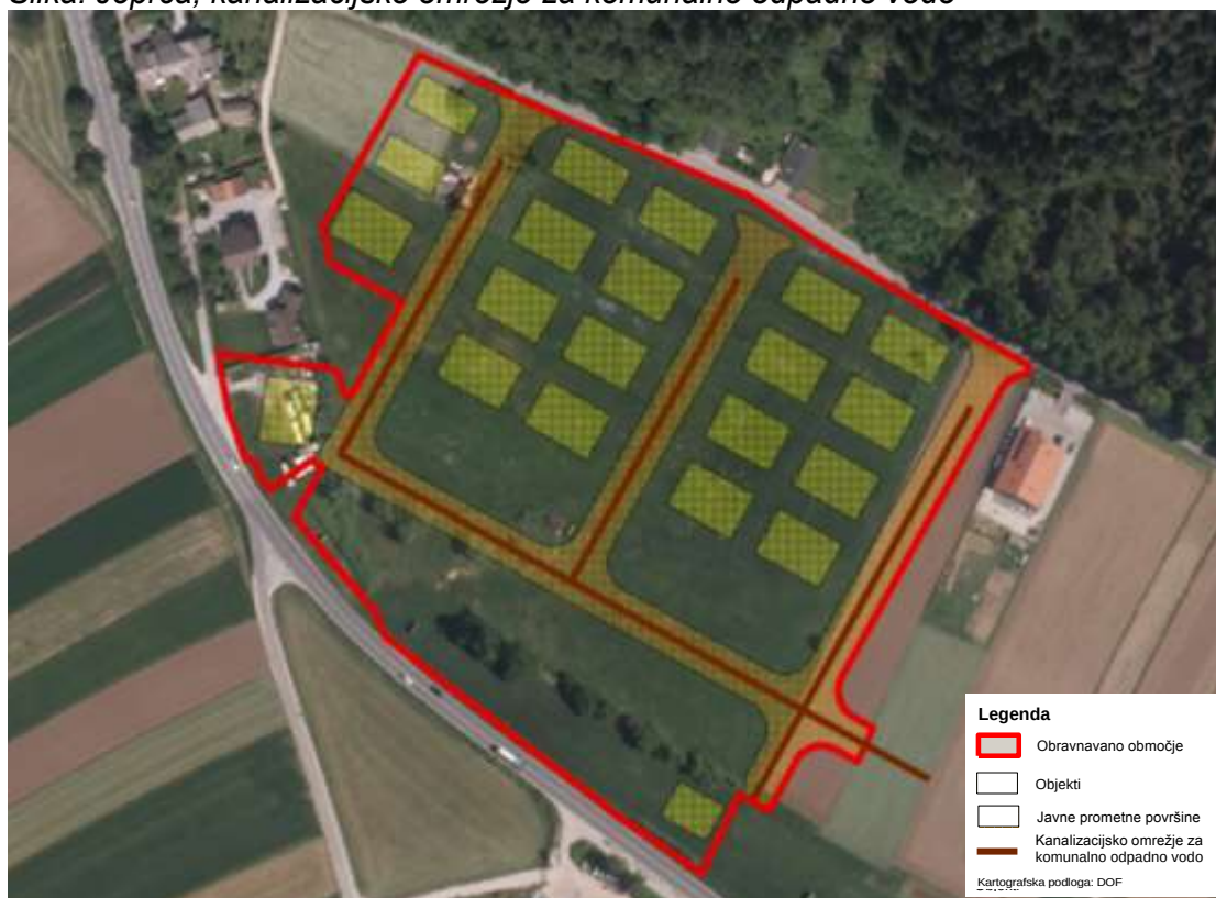
Slika: Jeprca, kanalizacijsko omrežje za komunalno odpadno vodo
