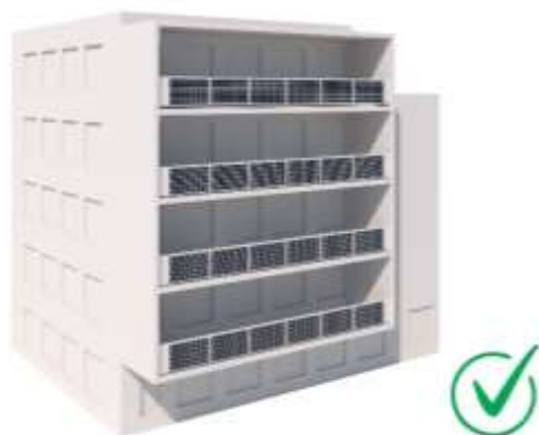
Slika 19: Primer ustrezne in usklajene umestitve fotonapetostnih naprav na balkone večstanovanjske stavbe
