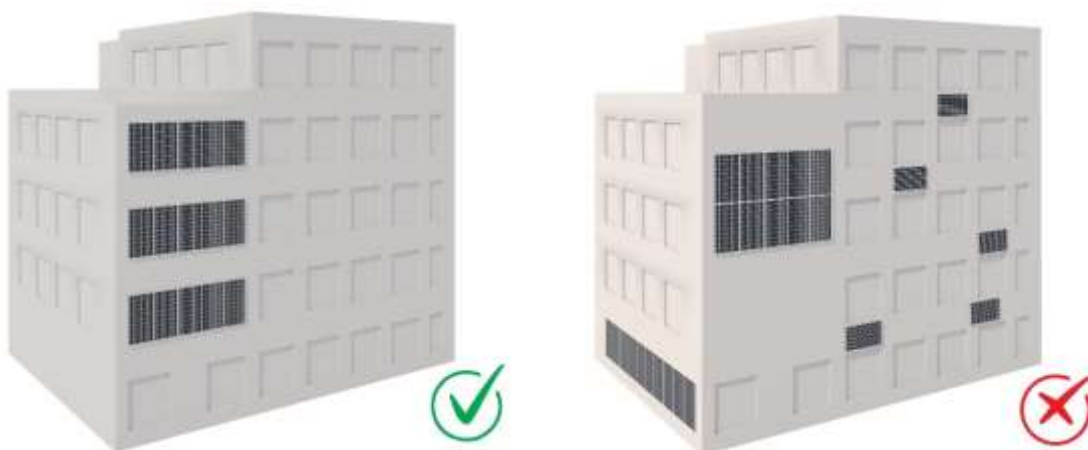
Slika 18: Primer ustrezne (leva slika) in neustrezne (desna slika) umestitve fotonapetostnih naprav na fasado večstanovanjske stavbe
