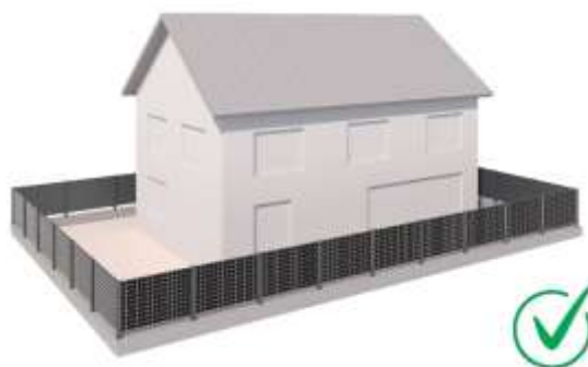
Slika 20: Primer ustrezne in usklajene umestitve fotonapetostnih naprav kot ograja ob stavbi
