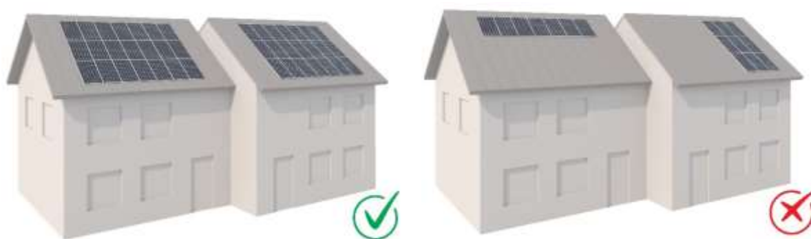
Slika 16: Primer usklajene in neusklajene postavitve fotonapetostnega modula pri vrstni pozidavi
