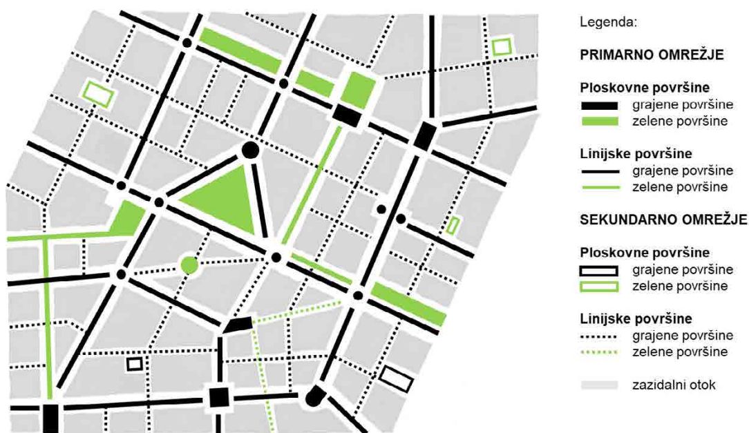
Slika 3.3: Shematski prikaz hierarhiziranosti omrežja javnih odprtih površin naselja na primeru kompaktnega mesta s ponazoritvijo tlorisne pojavnosti sestavnih delov (ploskovno/linijsko) in značaja (grajeno/zeleno).
