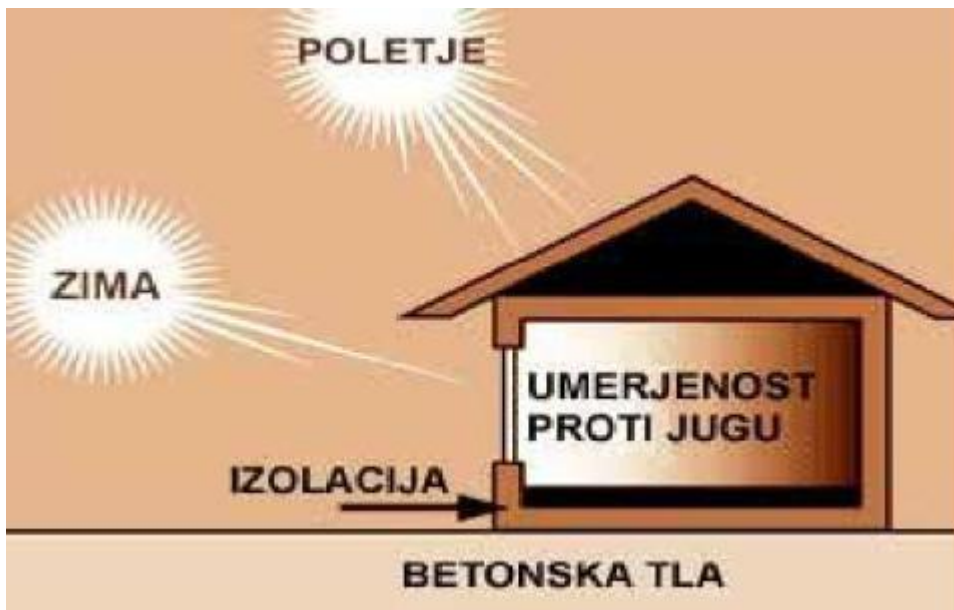
Slika 12: Princip pasivnega sočnega ogrevanja (Obnovljivi viri..., 2015)
