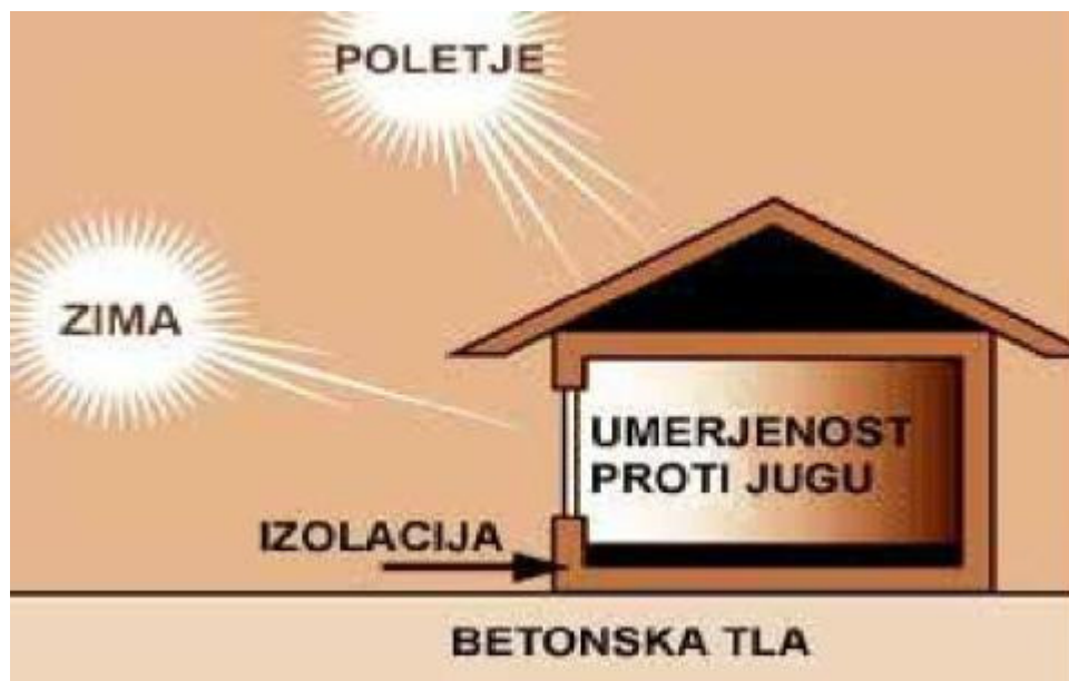
Slika 12: Princip pasivnega sočnega ogrevanja (Obnovljivi viri..., 2015)
