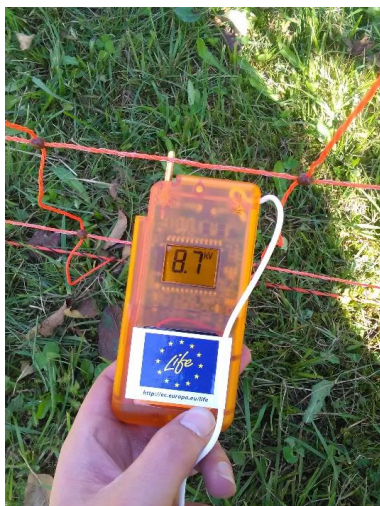
Slika 12: Merjenje višine napetosti z voltmetrom.
