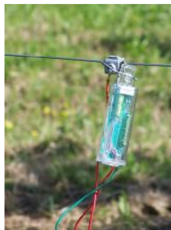
Slika: ... ali pa nam ustrezno delovanje elektroograjje prikazuje opozorilna lučka, ki zasveti ob vsakem pulzu, večjem od 3,5 kV.
