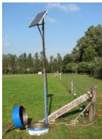
Slika: Akumulator za PA lahko napajamo preko sončnega panoja, vse skupaj pa ne pozabimo zavarovati s ključavnico.
