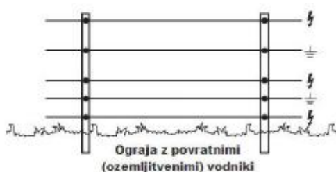
Slika: Elektroograj z povratnima vodnikoma (levo) in običajno postavljena elektroograj (desno).
