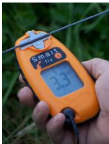
Slika: Napetost v elektroograjji lahko preverimo z digitalnim voltmetrom ...
