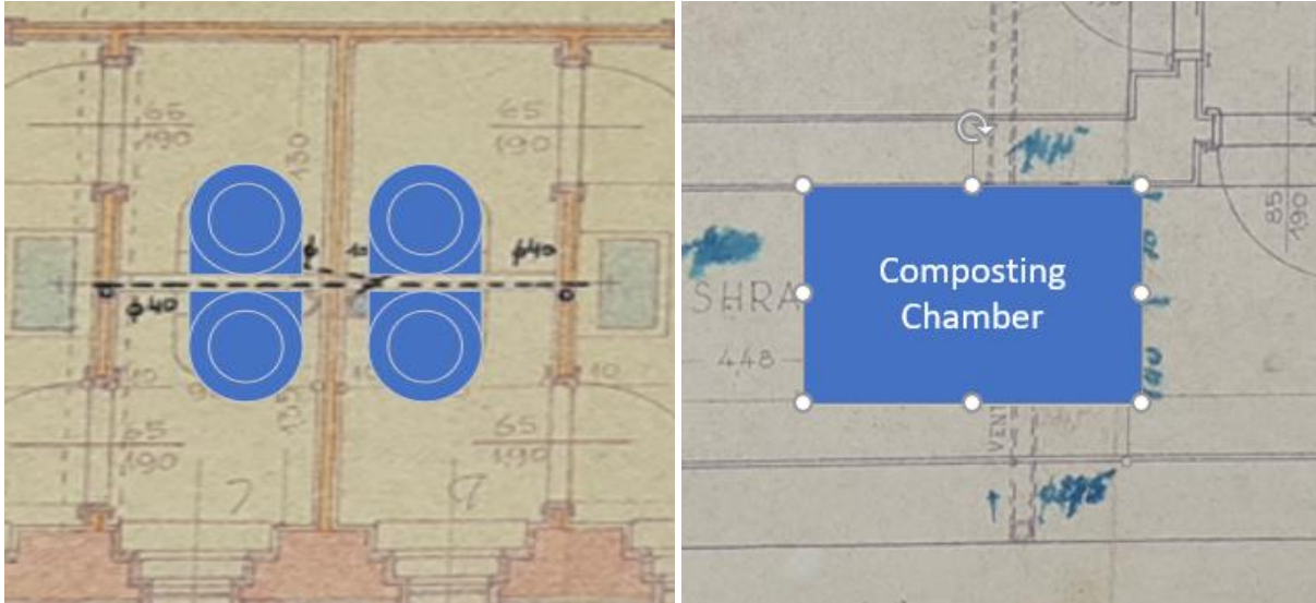
Slika 23: Umeščanje kompostnih stranišč v pritličju zgradbe (levo) in kompostnika v kleti (desno).
