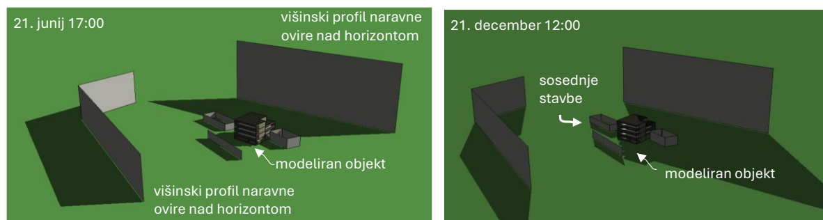
Slika 90: Grafični prikaz naravnih ovir in sosednjih stavb, ki senčijo modelirano stavbo; modelirana in referenčna stavba sta enako senčeni !
