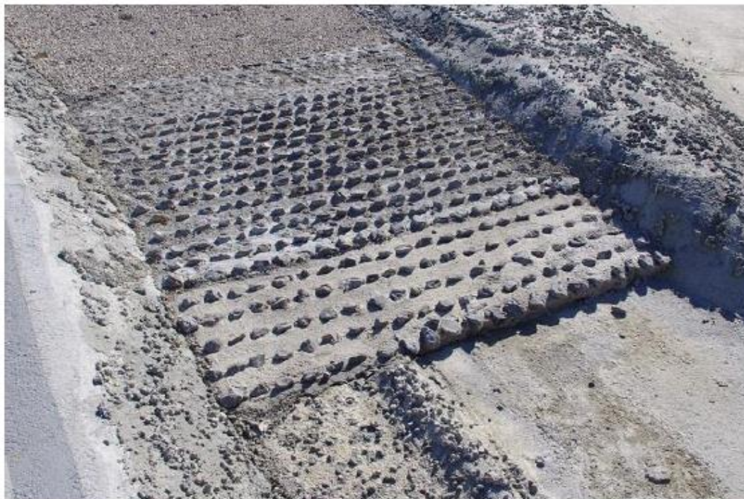
Slika 26: KAMNITA DRČA Z NAKLONOM 1:40 NA FIZIČNEM HIDRAVLIČNEM MODELU IZLIVNEGA ODSEKA KRKE V MERILU 1:30
