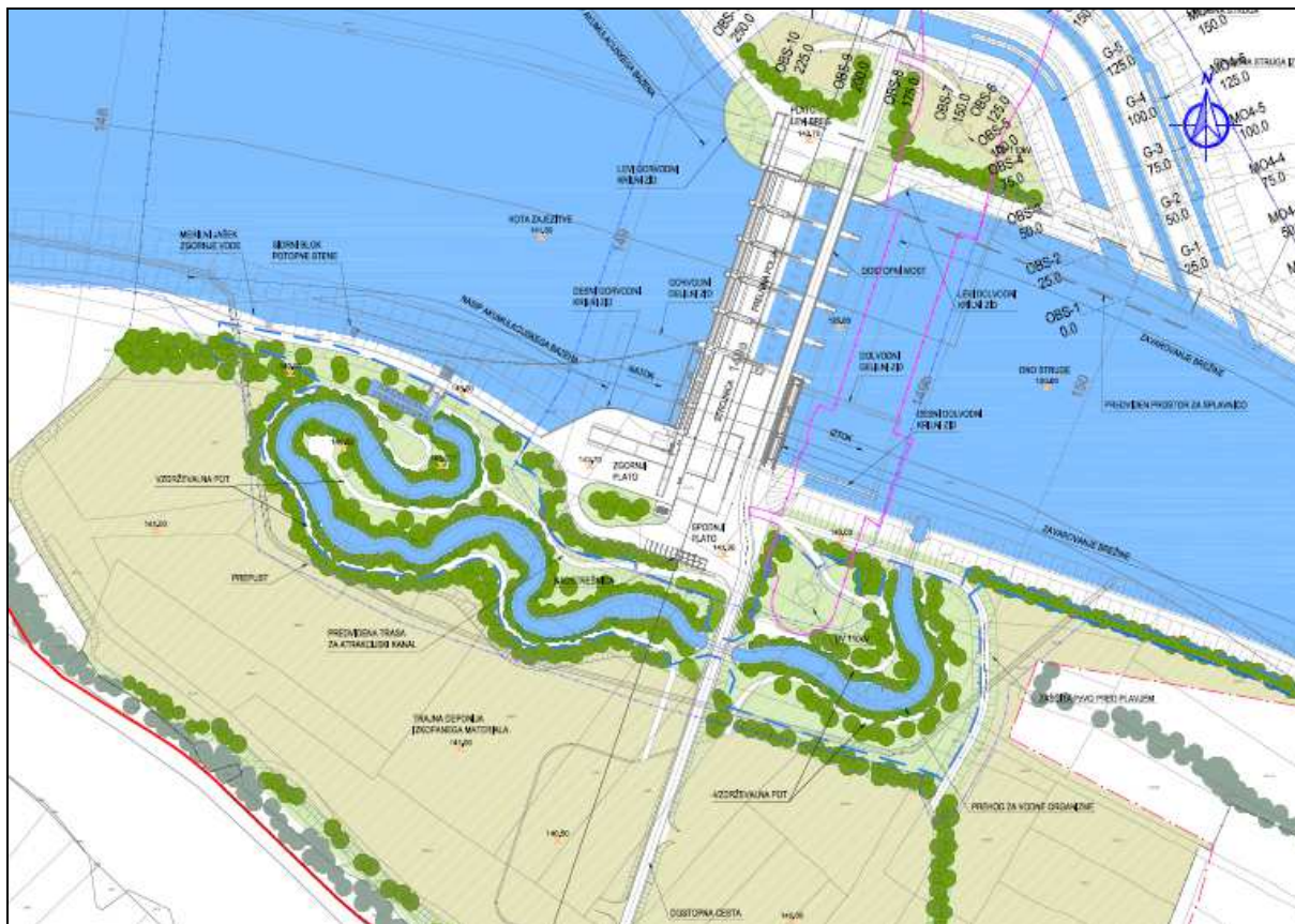
Slika 6: Prikaz umestitve prehoda za vodne organizme
