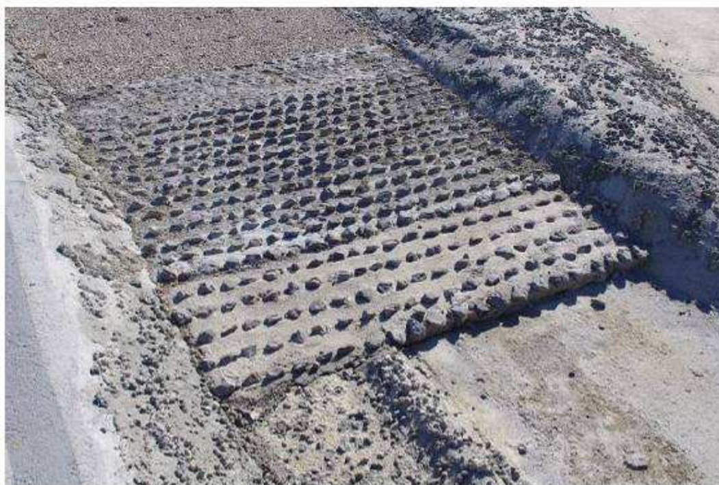
Slika 12: Kamnita drča z naklonom 1:40 na fizičnem hidravličnem modelu izlivnega odseka Krke v merilu 1:30
