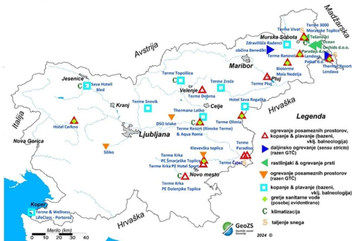
Slika 32: Uporabniki toplote iz geotermalne energije (termalne vode) v Sloveniji po kategorijah direktne rabe (stanje: 31. dec. 2023); prikazan je tudi daljinski sistem ogrevanja v Benediktu, ki deluje z globoko geosondo in ne izkorišča termalne vode.
