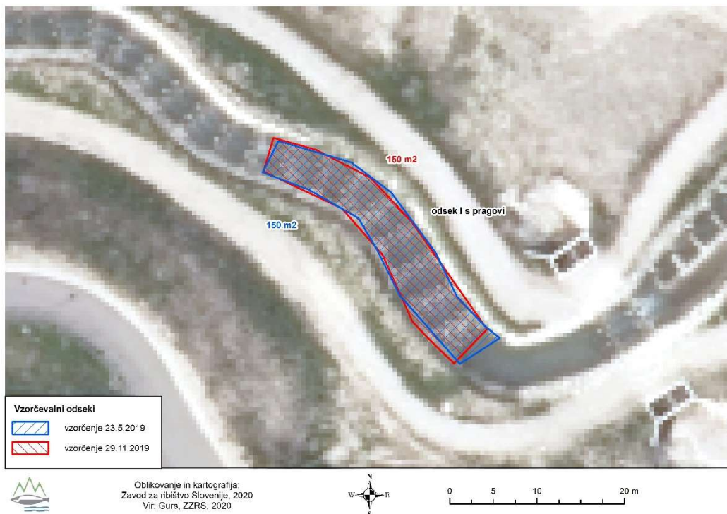
Slika 8: Prikaz površin vzorčenega odseka »odsek I s pragovi« v prehodu HE Brežice.
