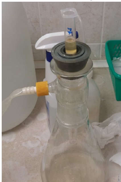
Slika 18: Ekstrakcija fenolnih spojin s kolono Strata X
