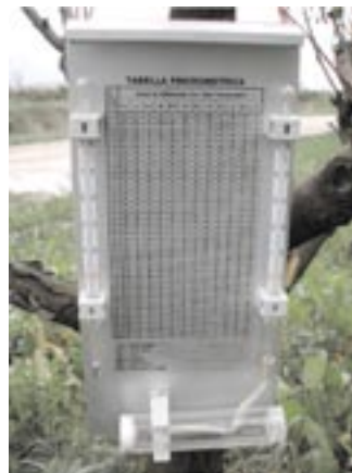
Slika 5: Psihrometer: mokri in suhi termometer
