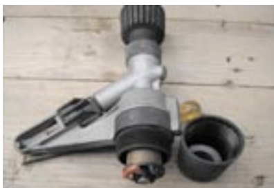
Slika 12: Odstranimo kapico in varovalko, zategnemo vzmet in ponovno namestimo varovalko in kapico
