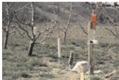
Slika 19: Alarmna naprava domače izdelave - akumulator, mokri termometer in oddajnik
