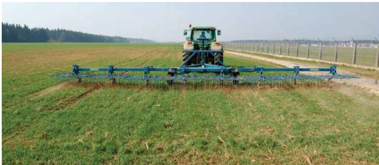
Slika 3: S česali v žitih zatiramo plevele in prekinemo kapilarni dvig vode.
