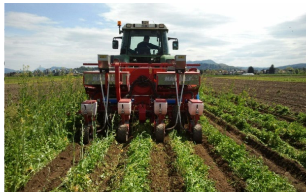
Slika 2: Trakasti način obdelave tal (ang. strip till)
