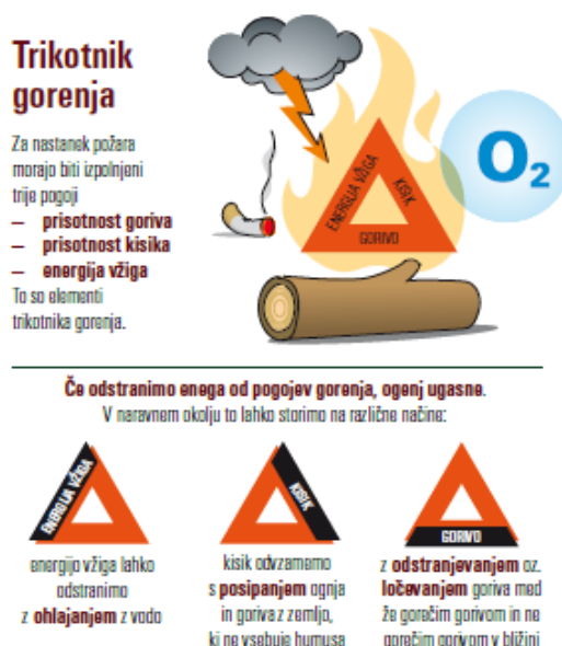
Slika 6: Požarni trikotnik, temperatura, energija vžiga
