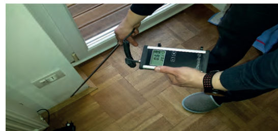
(85) Anemometer – merilnik hitrosti gibanja zraka oz. vetra.
