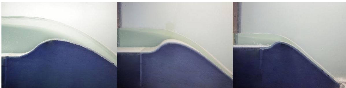
Slika 2.5: Primerjava prelivnega curka na modelih 1:26 (leva fotografija), 1:50 (srednja fotografija) in 1:100 (desna fotografija) za nominalni pretok (t.j. pretok na prototipu) 214 m³/s
