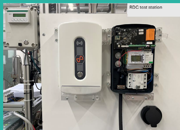
Testna naprava za RDC polnilnico, ki je integrirana v digitaliziran sistem
