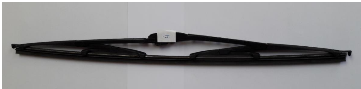
Slika 54: Izpostavljeni avtomobilski brisalci na območju stalne prisotnosti vran so po 29-ih dneh izpostavitve ostali nepoškodovani; vzorci 1–4 (foto: Z. Pavšek).
