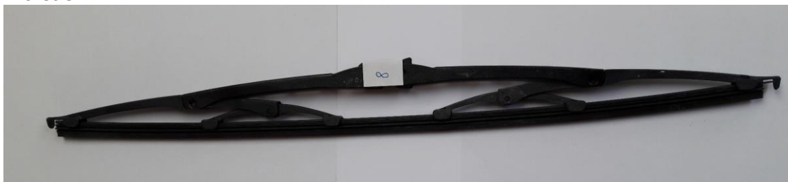
Slika 55: Izpostavljeni avtomobilski brisalci na območju stalne prisotnosti vran so po 29-ih dneh izpostavitve ostali nepoškodovani: vzorci 5 – 8 (foto: Z. Pavšek).
