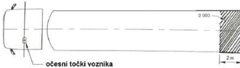
Slika 12: Vidno polje, ki ga zagotavljajo naprave za posredno gledanje, nameščene na zadnjem delu vozila
